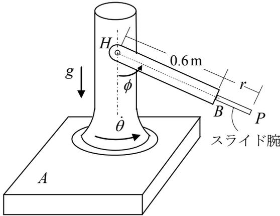
補足図5.2 ロボットアームのモデル
