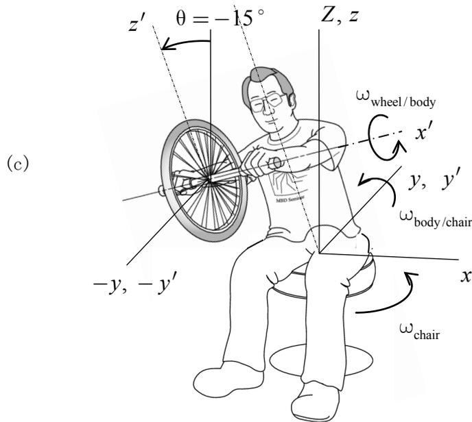
補足図5.1 車輪の角速度
